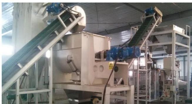
Usamos um misturador totalmente automático para distribuir uniformemente as fibras de vidro brutas, garantindo a resistência da placa enquanto reduz os erros de espessura.
